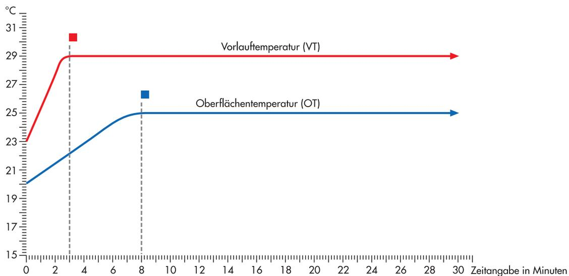
■ Die Vorlauftemperatur von 29°C wird innerhalb von 3 Minuten erreicht. ■ Die Oberflächentemperatur von 25°C wird nach 8 Minuten erreicht.
